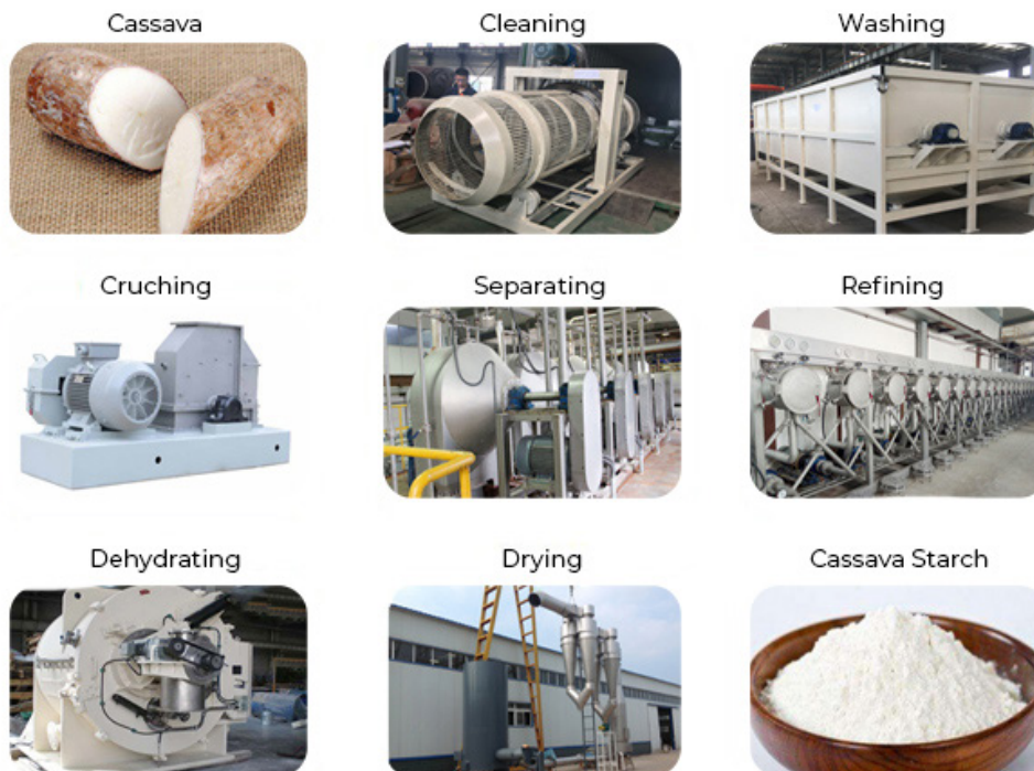
Gambar 1. Alur Produksi Tepung Tapioka (Sumber: www.cassavastarchmachine.com )
